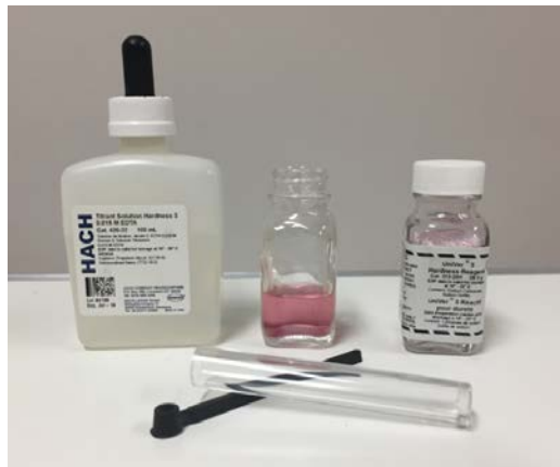
Figure 8 : Ensemble d'analyse facile d'utilisation qui indique la dureté de l'eau par le nombre de gouttes ajoutées jusqu'au changement de couleur de la solution. (ex. : trois gouttes pour changer la couleur du rose au bleu correspondent à trois grains de dureté).
