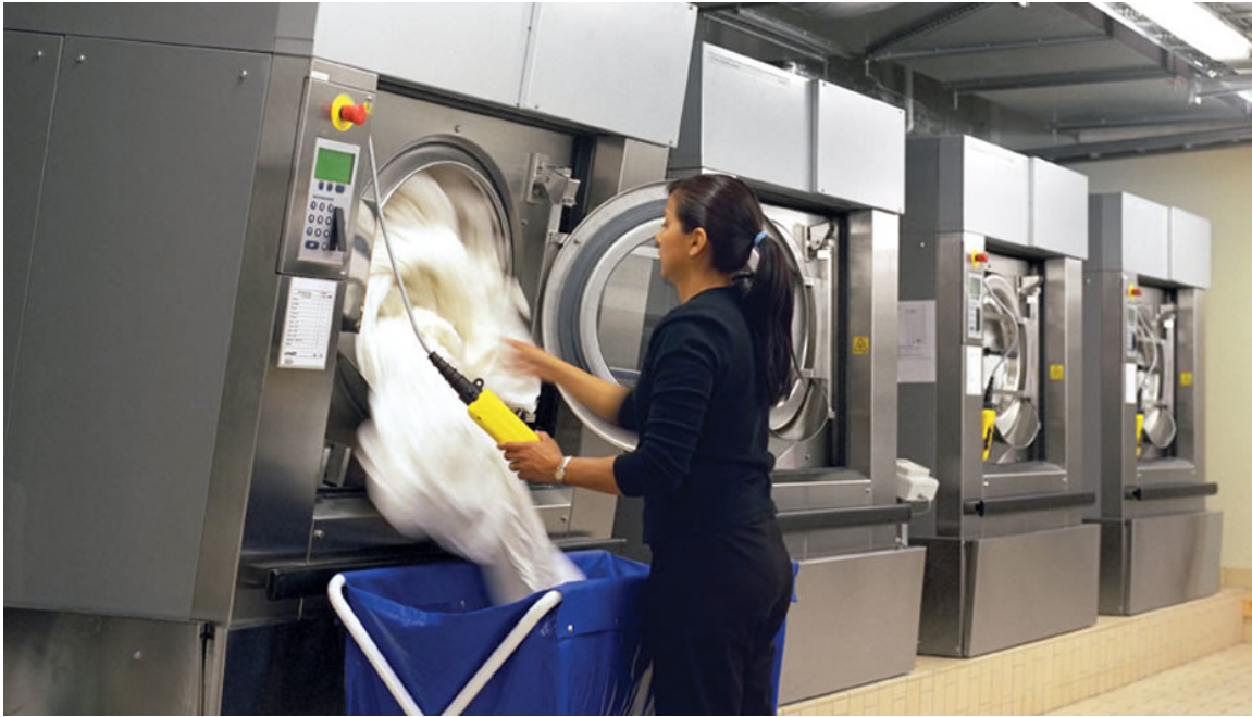
Figure 9 : Laveuse-essoreuse avec bascule
