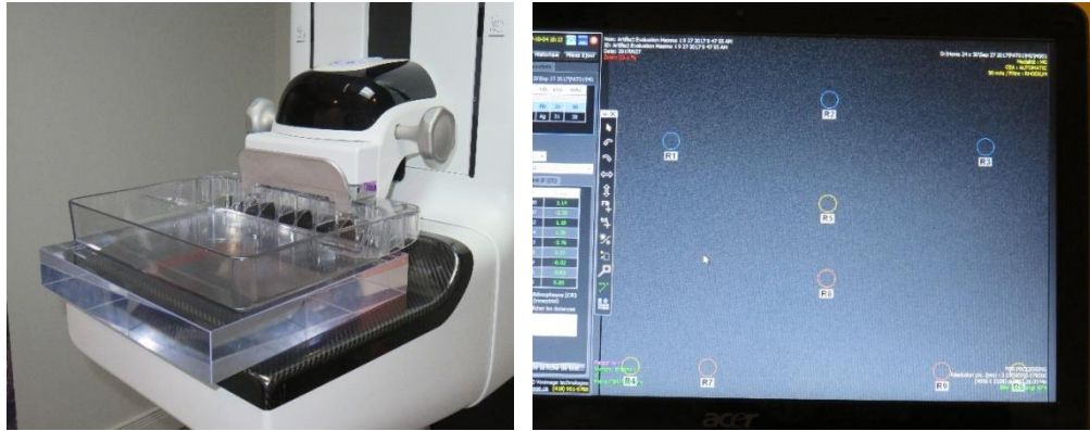
Figure 17 Bloc d'acrylique radiographié pour déterminer l'homogénéité du système à partir de neuf régions d'intérêt illustrées
