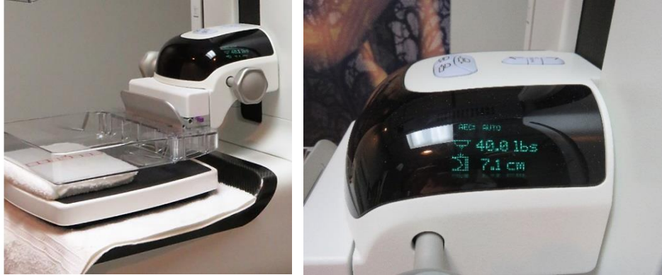
Figure 26 Positionnement du pèse-personne pour mesurer la compression et affichage des mesures sur le mammographe
