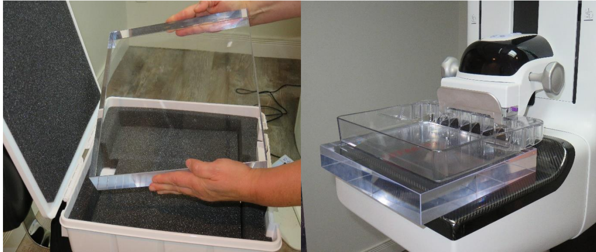
Figure 9 Radiographie d'un bloc d'acrylique pour l'évaluation des artefacts
