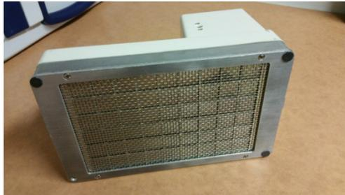
En cas de perte de grain, un compteur proportionnel à grande surface de détection peut être utile pour un premier relevé afin de circonscrire la région de la salle où se trouve le grain. On utilise ensuite une plus petite sonde pour localiser le grain avec précision.
